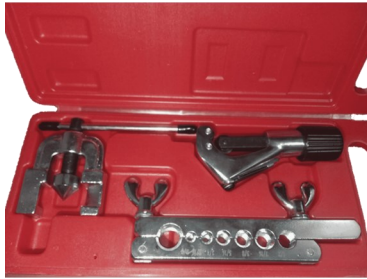
Juego De Prensa Con Cortatubo RTK-002
