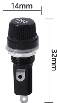
Portafusibles Europeo 15A 125VAC, 10A 250VAC 5X20MM
